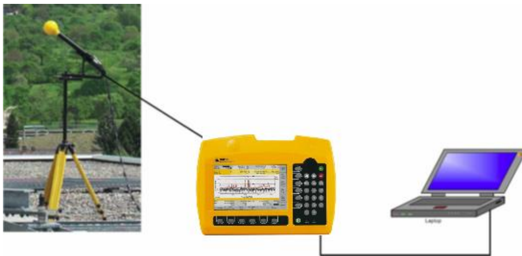
Εικόνα 2. Διάταξη μέτρησης (κεραία / κύρια μονάδα / φορητός υπολογιστής)
