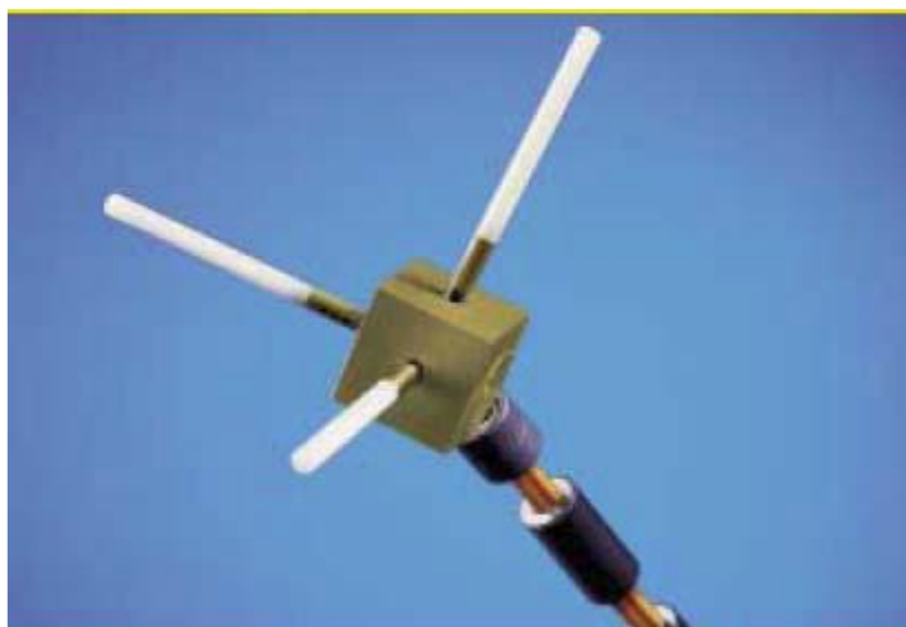
Εικόνα 1. Ισοτροπική κεραία μέτρησης της συσκευής SRM
