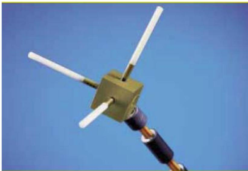
Εικόνα 1. Ισοτροπική κεραία μέτρησης της συσκευής SRM
