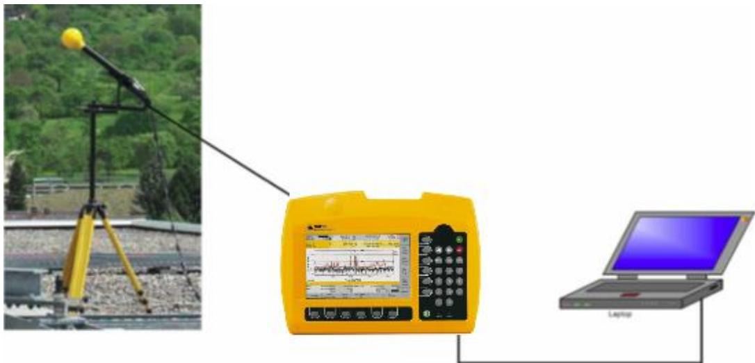
**Εικόνα 2. Διάταξη μέτρησης (κεραία / κύρια μονάδα / φορητός υπολογιστής)**
