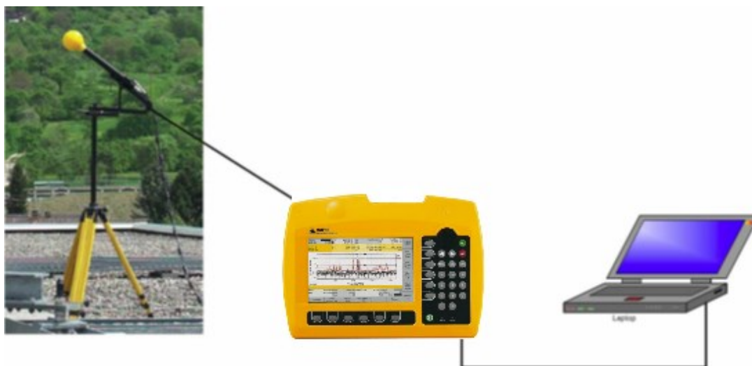
Εικόνα 2. Διάταξη μέτρησης (κεραία / κύρια μονάδα / φορητός υπολογιστής)
