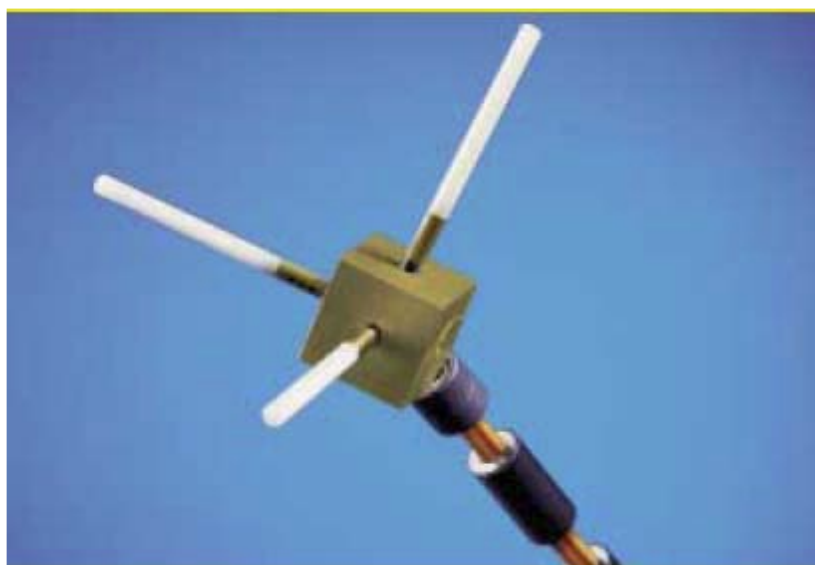
Εικόνα 1. Ισοτροπική κεραία μέτρησης της συσκευής SRM
