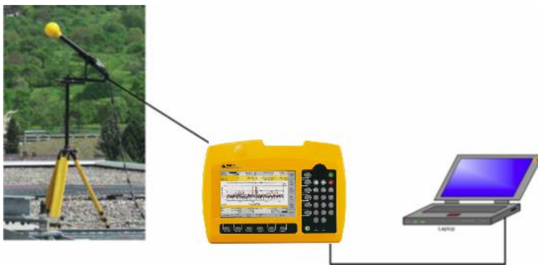
Εικόνα 2. Διάταξη μέτρησης (κεραία / κύρια μονάδα / φορητός υπολογιστής)
