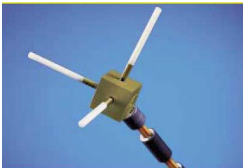
Εικόνα 1. Ισοτροπική κεραία μέτρησης της συσκευής SRM
