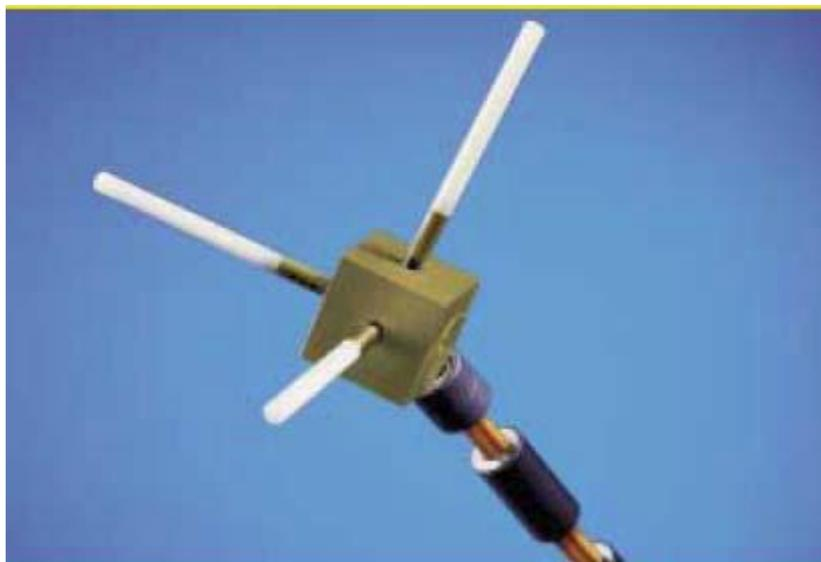
**Εικόνα 1.** Ισοτροπική κεραία μέτρησης της συσκευής SRM
