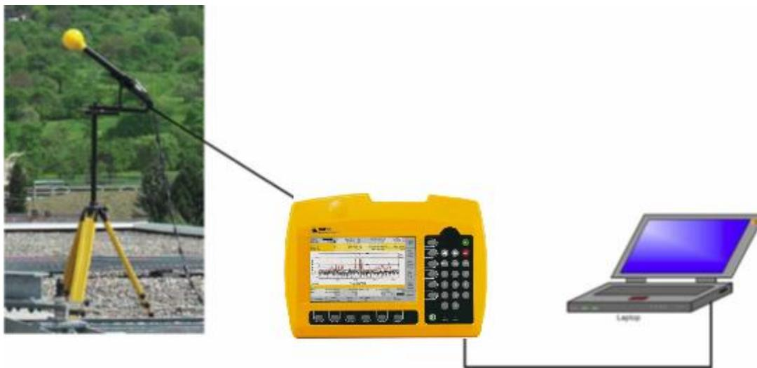
**Εικόνα 2.** Διάταξη μέτρησης (κεραία / κύρια μονάδα / φορητός υπολογιστής)
