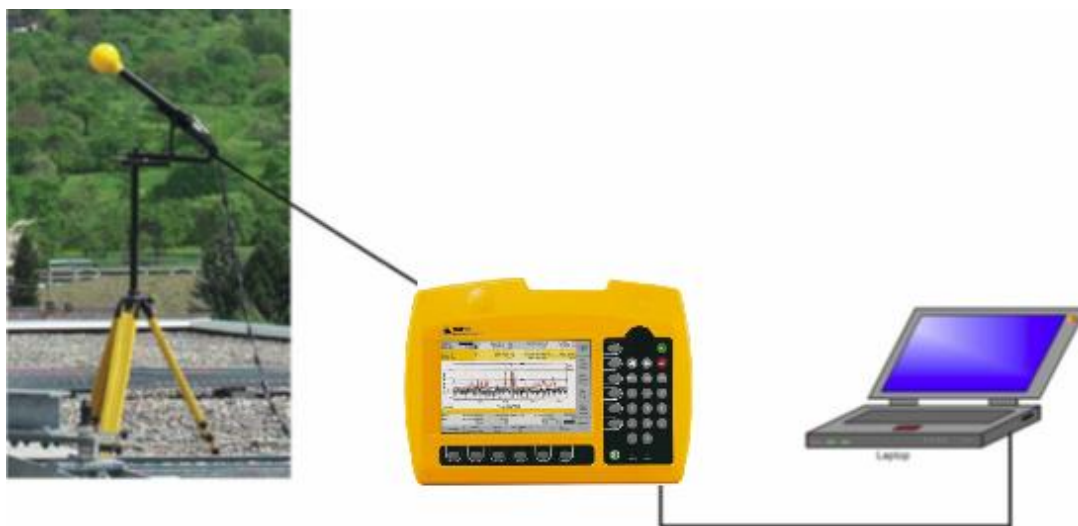
Εικόνα 2. Διάταξη μέτρησης (κεραία / κύρια μονάδα / φορητός υπολογιστής)
