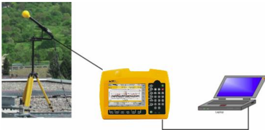
Εικόνα 2. Διάταξη μέτρησης (κεραία / κύρια μονάδα / φορητός υπολογιστής)
