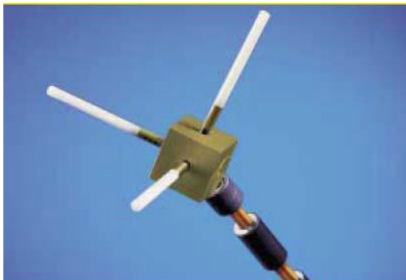
Εικόνα 1. Ισοτροπική κεραία μέτρησης της συσκευής SRM
