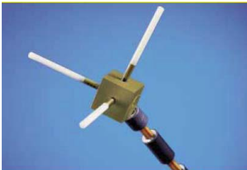
Εικόνα 1. Ισοτροπική κεραία μέτρησης της συσκευής SRM
